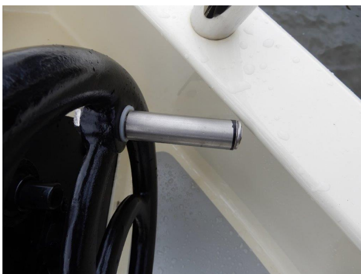
Jaagwiel van de anker winch met ingekorte pen.
