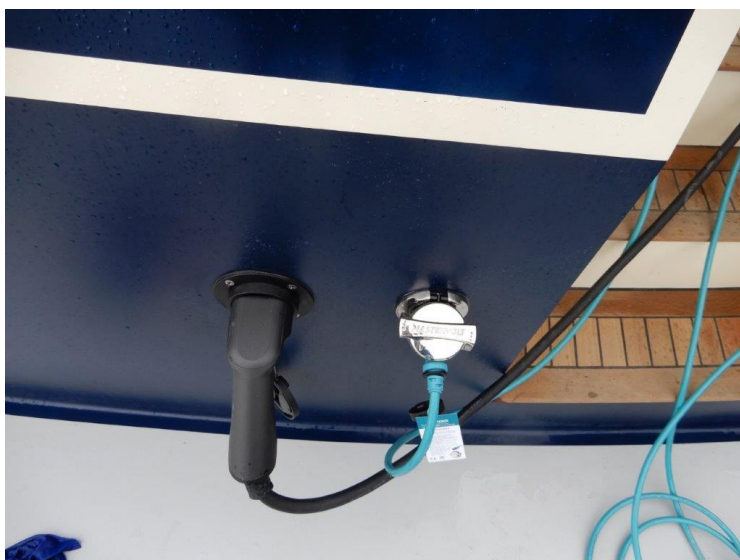
Laad stroom stopcontacten voor het laden via de walstroom. 380 Volt voor het laden van de accu's van de voorstuwingsinstallatie.
