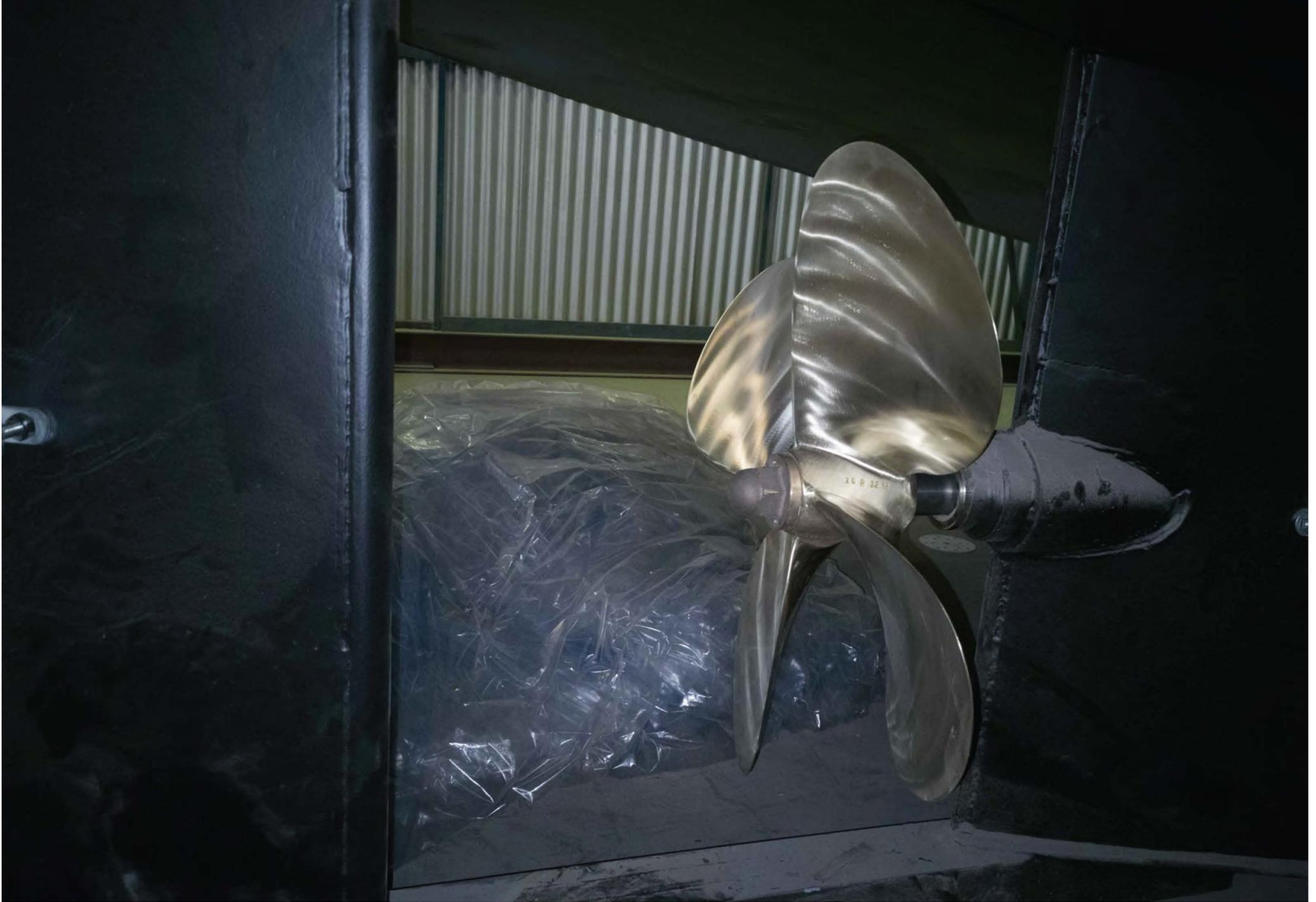
Propeller sieht zwar schön aus, ist aber der Propeller für den Dieselmotor. Wir glauben nicht, dass dieser Propeller die richtige Dimension hat für den Elektromotor im Verhältnis zur Drehzahl ( 1:3 anstatt 1:2)
