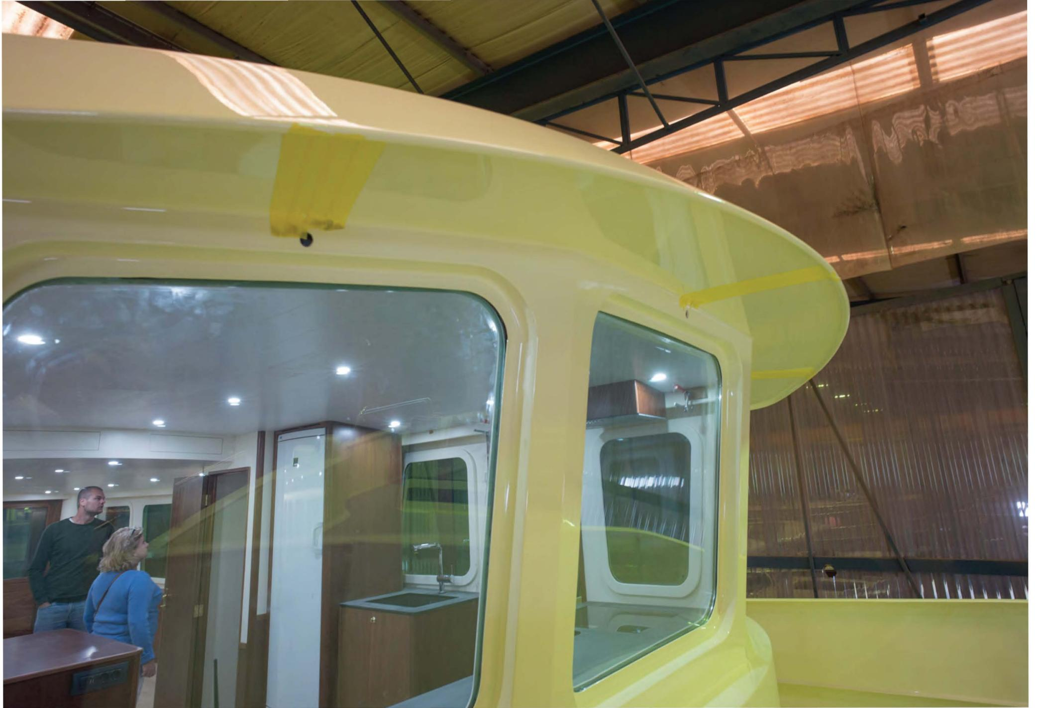
LED Lampen Aussenseite fehlen. Kittfugen an den Fenstern fehlen. Scheibenwischer fehlen.
